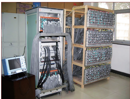
BES III 量能器电子学小系统测试运行环境
