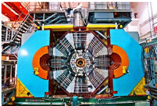
图5 安装在对撞区的北京谱仪 BESIII
