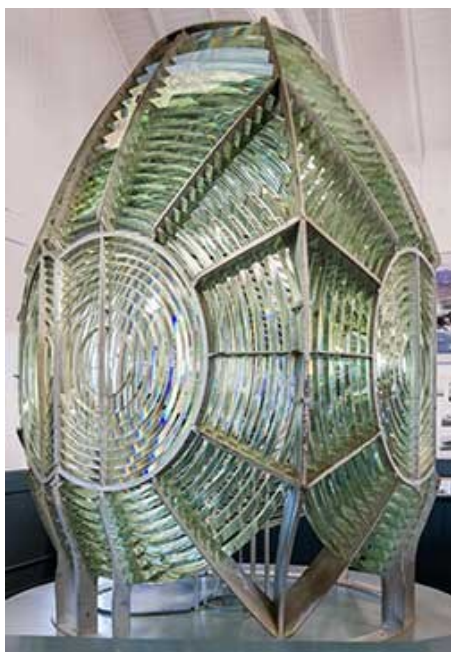
图2 美国加州 Point Arena 灯塔的菲涅耳透镜 Photo: Wikimedia commons/Frank Schulenberg
