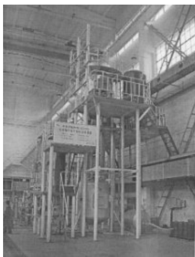
图3 虹吸破坏试验装置
