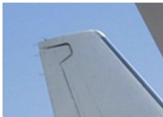
图10 方向舵集中式配重放大图
