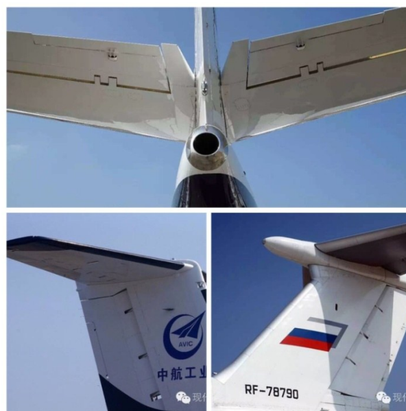
图11 舵面转轴(铰链)适当后移的飞机尾翼
