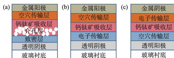
图1 钙钛矿太阳能电池结构(a)介孔结构,(b)正置平面异质结构,(c)反置平面异质结构
