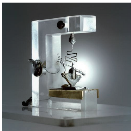
图3 点接触晶体管发明时的装置
