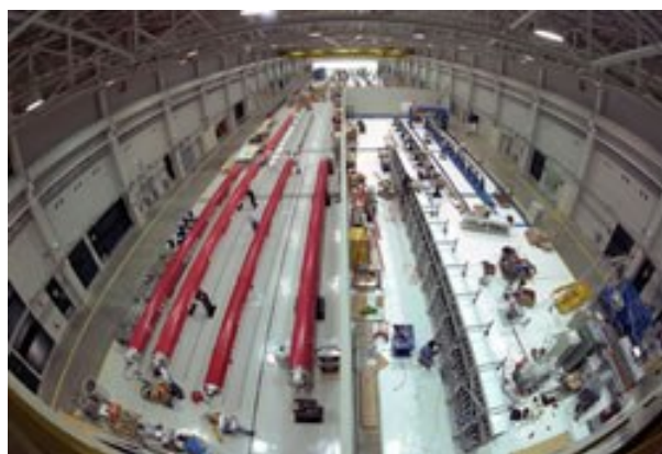
原磁铁发展实验室的内部,技师在里面盘绕超导的铌线圈,做成强力磁铁
