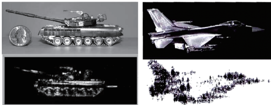
图3 T80坦克和F16战机模型及太赫兹成像结果
