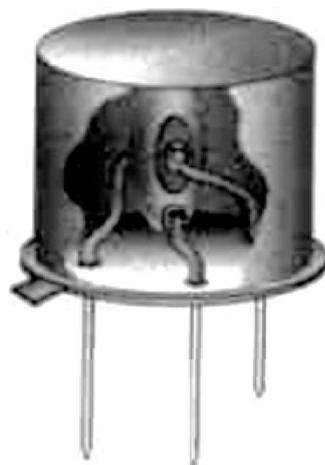
图76 TO型金属封装
