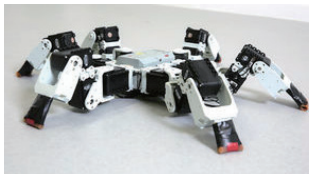
左图为六脚机器人，右图为该机器人采取三点步法（上）和两点步法（下）的对照视频截图，两点步法速度明显快于三点步法
