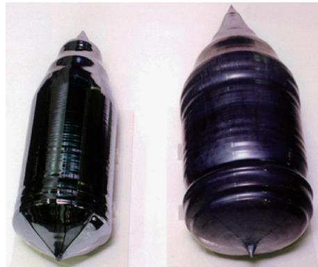
图 43 直径 300mm 和 400mm 的硅锭
