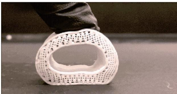
(Northwestern University)的沙阿(R. Shah)和同事利用羟磷灰石(hydroxyapatite, 自然骨骼中的一种类似成分)混合两种聚合物打印出“超弹性骨头”,并已用于医学实验,植入老鼠和猕猴体内的样本与自身组织成功整合,促使新骨生长而无负面影响。打印“骨”就像人类的股骨形状,足以承担自然负荷,而且易于打印成各种不同形状,这是一项前途无量的新技术。
