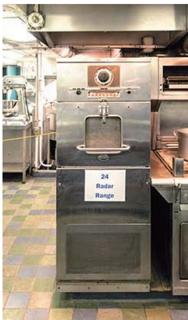
第一台微波炉重300多千克，需要以水冷却，要价以现在的币值计52000美元。当时装置在核动力的萨瓦那号（Savannah）货轮上
