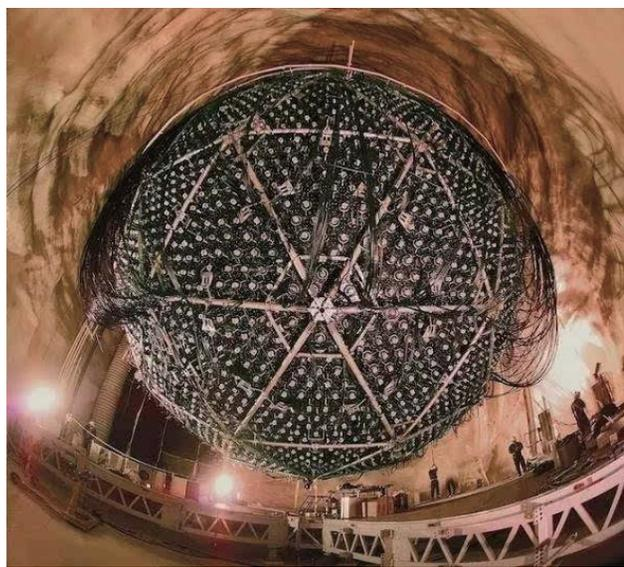
图2 安装过程中的SNO探测器。（苏伦斯·伯克利国家实验室供图）
