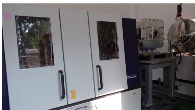
图 10 100 米束线的光源部分 (18 kW 的 X 光机和单色器)
