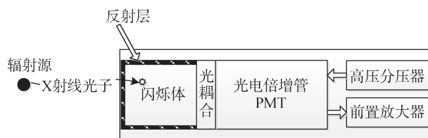
图2 闪烁体探测器的组成示意图
