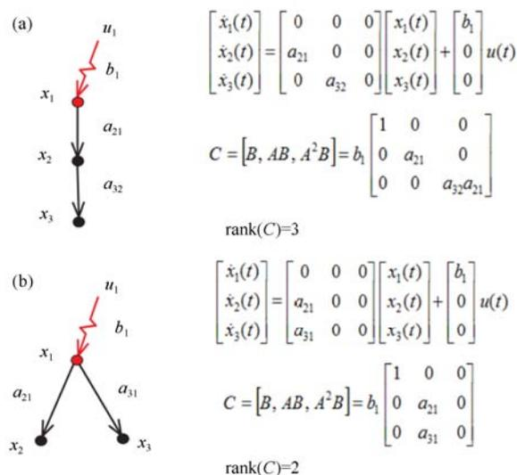
图3 具有外部输入的系统结构可控性示意图
