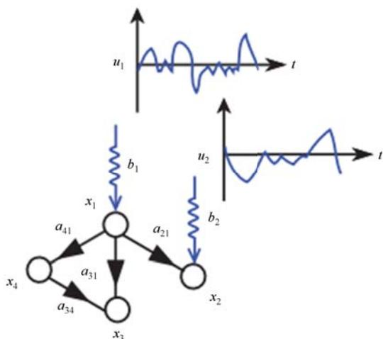
图2 线性系统外界输入结构示意图
