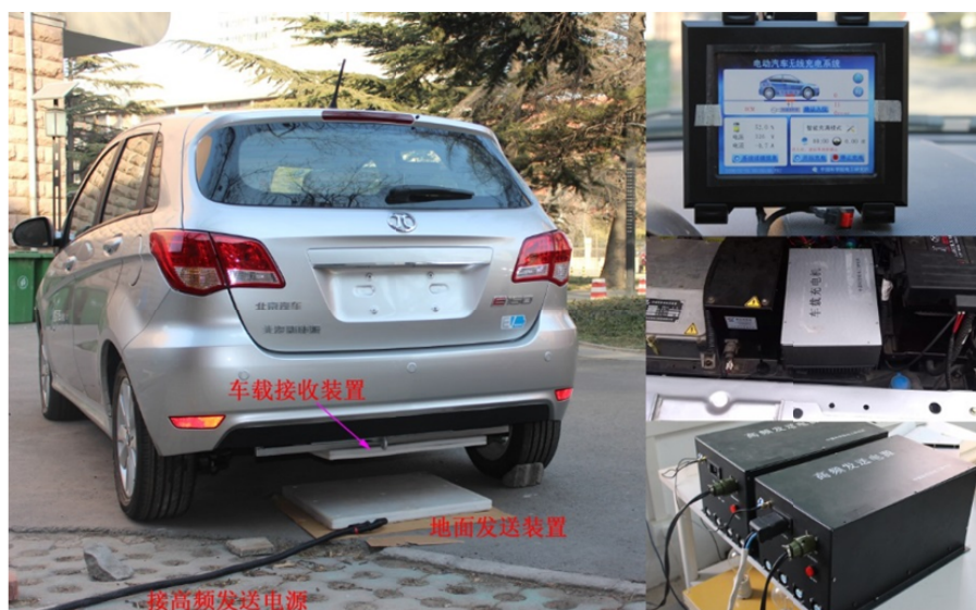
图5 中国科学院电工研究所研制的电动汽车无线充电系统（左图：实车图片，右上图：车载终端，右中图：车载充电机，右下图：地面高频电源图）
