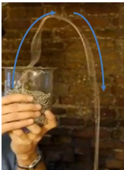
图6 链条“喷泉”现象。让杯子中的长链一端下落，另外一端会跳出杯子，形成一个弯弧
