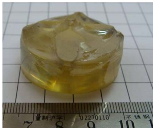
图4 采用 TSSG 方法生长的 (\text{Bi}_{0.5}\text{Na}_{0.5})\text{TiO}_3-5\% \text{BaTiO}_3 单晶 (NBBT95/5)
