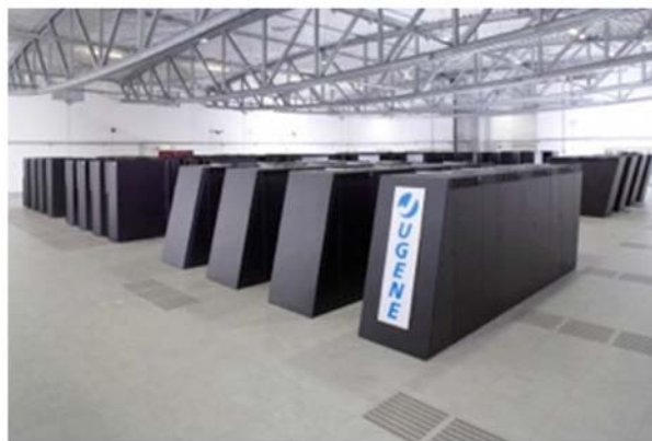
图4 德国 Juelich 超算中心的 IBM Blue Gene/P 超级计算机, 浮点运算峰值为 1 千万亿次每秒。其中 IDRIS/CNRS 51.5 万亿次的计算资源供格点量子色动力学模拟专用(BMW 合作组)
