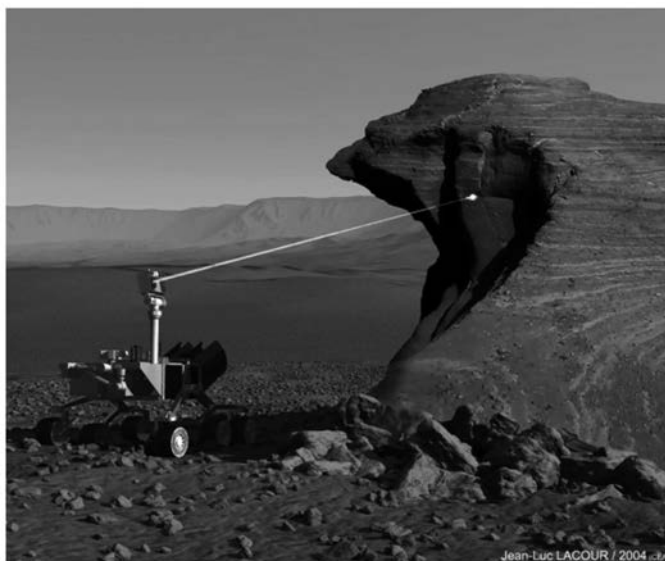
图3 NASA 火星 LIBS 遥测示意图
