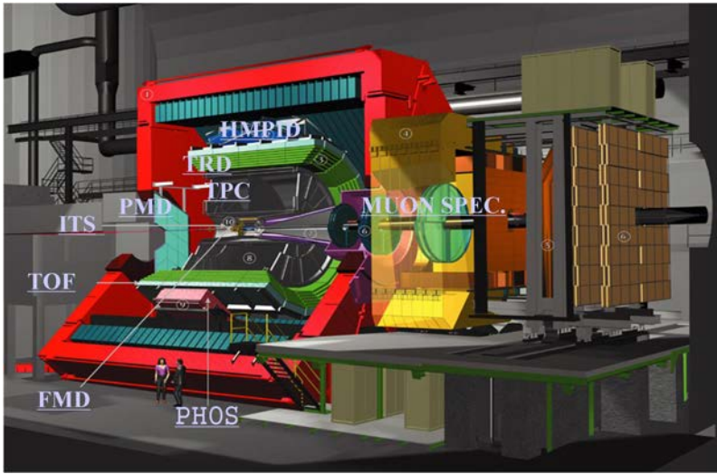
图3 ALICE实验装置。包括：高横动量粒子鉴别探测器(HMPID)，跃迁辐射探测器(TRD)，时间投影室(TPC)，光子多重性探测器(PMD)，内部跟踪系统(ITS)，飞行时间探测器(TOF)，前向多重性探测器(FMD)，光子谱仪(PHOS)， \mu 子谱仪(MUON SPEC)，红色的部件是磁铁。此外还有图中没有示出的电磁量能器及零度中子量能器等
