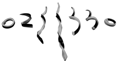
图4 不同裁剪角对应的螺旋形状
