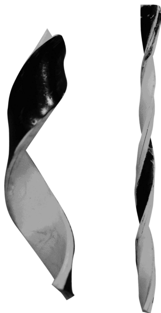
图6 圆柱面宽条剪开后成纯扭窄条
