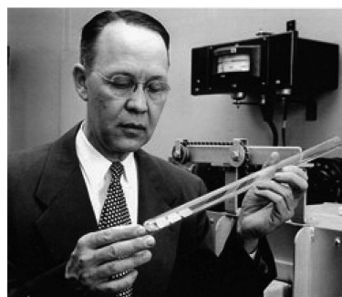
福勒将硼注入硅中，制成全球 第一个太阳能电池
