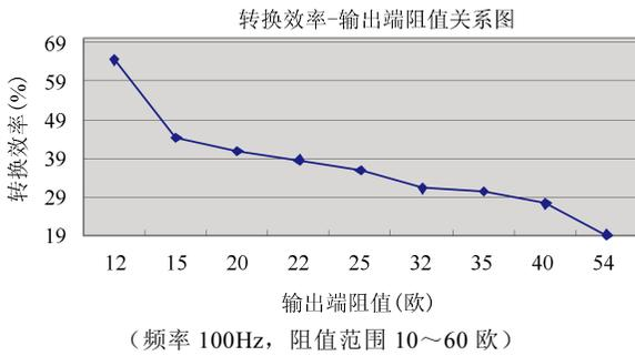
我们经过多次实验得出：相位差与输出端阻值正相关，且当阻值趋于无穷时相位差趋于一个有限值，转换效率则随阻值反相关（由上图也可得出类似结论）。
