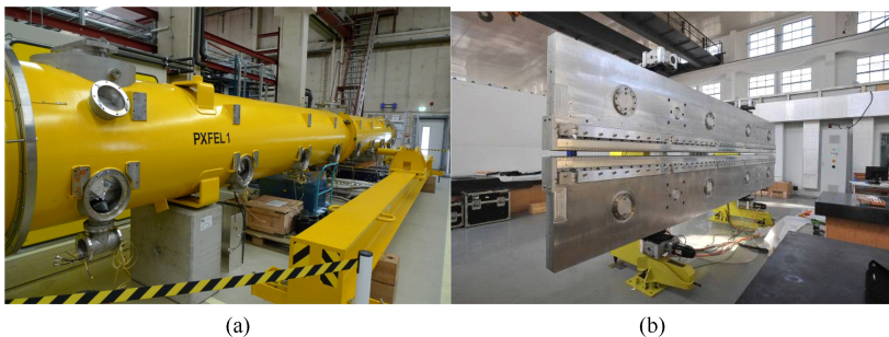
图 14 中科院高能所研制的 (a) EXFEL 恒温器样机; (b) EXFEL 波荡器样机
