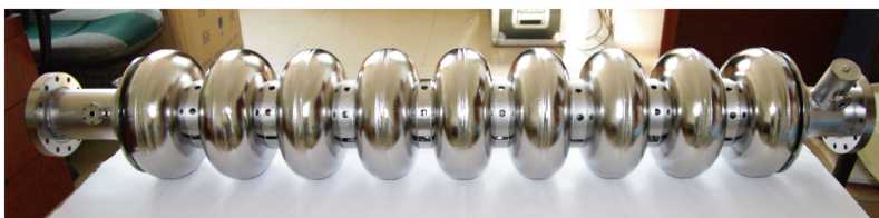
图 16 北京大学基于高纯钽片所研制的大晶粒 9-cell 超导腔
