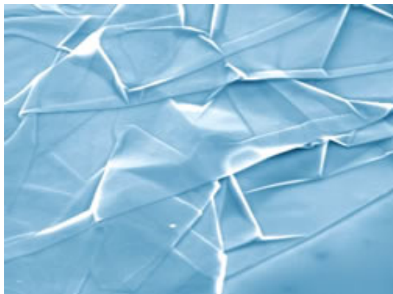
硅芯片上极皱的石墨烯片的扫描电子显微照片 (荷兰基础物质研究基金会)
