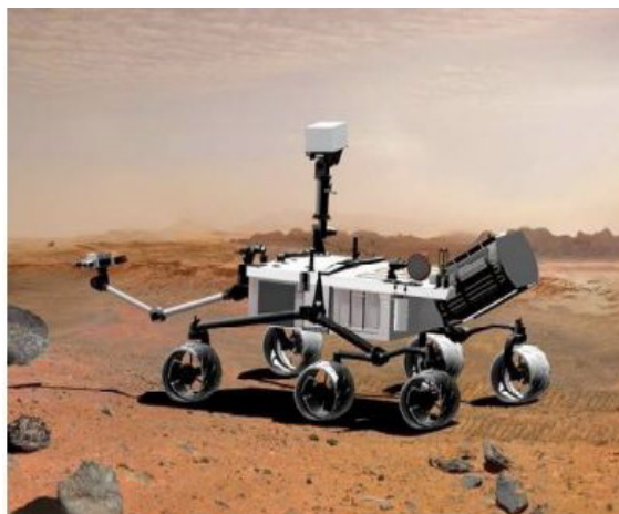
图 3 “好奇号”火星越野车（右侧为 RTG）
