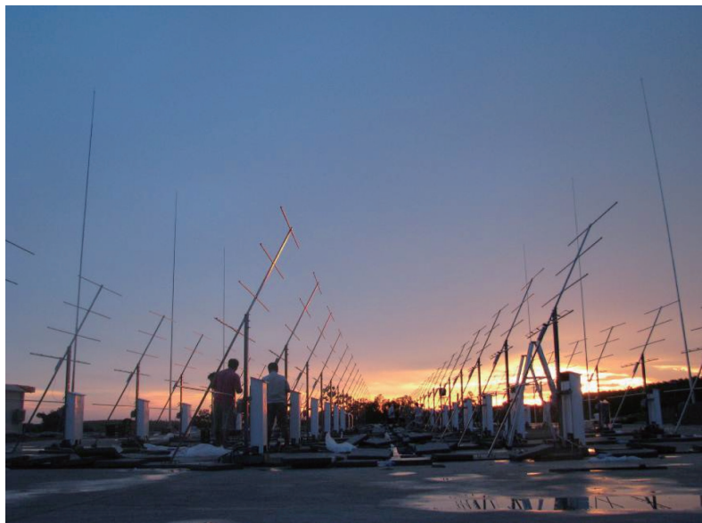
图3 子午工程海南富克观测站甚高频相干散射雷达天线阵
