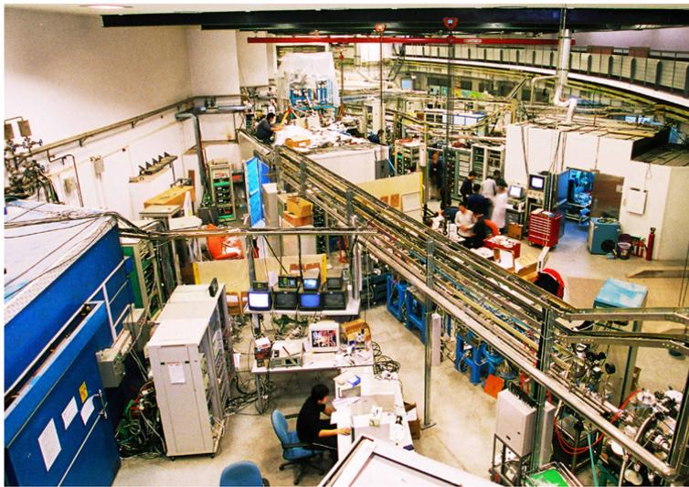
北京正负电子对撞机的同步辐射装置，1988 年开始运行，2008 年进行升级
