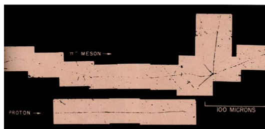
图 3 \pi 介子的发现，显示了多张胶片拼接成的粒子径迹 (图片来自劳伦斯伯克利实验室网站)
