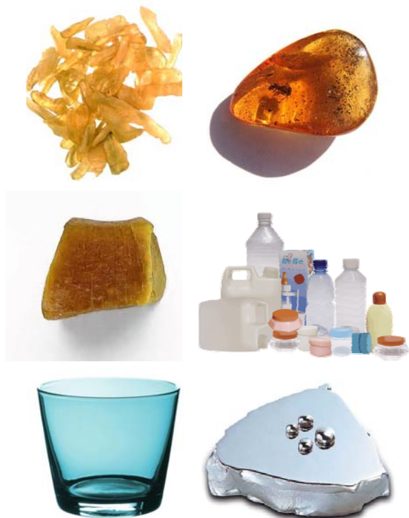
图4 常见的非晶态物质 依次是火山玻璃、琥珀、天然橡胶、 塑料、普通玻璃、金属玻璃
