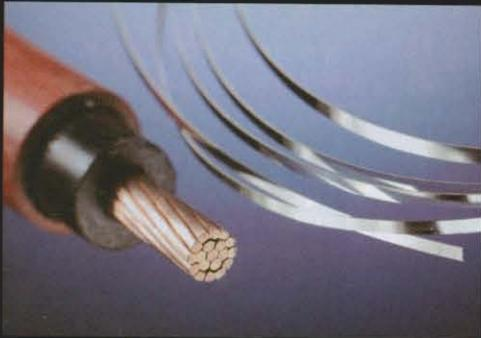
▲ 高温超导输电线和带材
