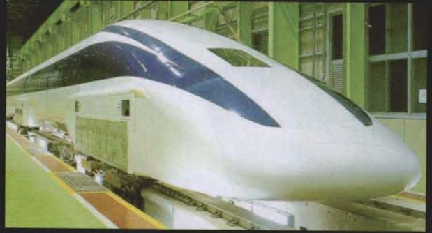
▲ 日本铁路研究所的超导磁悬浮试验车
