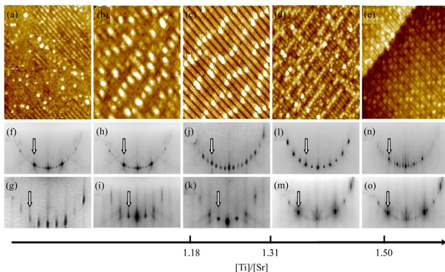
图 9 SrTiO<sub>3</sub>(110)表面重构随表面金属 Ti 与 Sr 浓度比例的演化。(a)~(e)依次是(5×2)、(5×1)、(4×1)、(2×8)、(6×8)的 STM 图像。(f)~(o)不同重构相分别沿[001]和[1-10]晶向的反射式高能电子衍射图案
