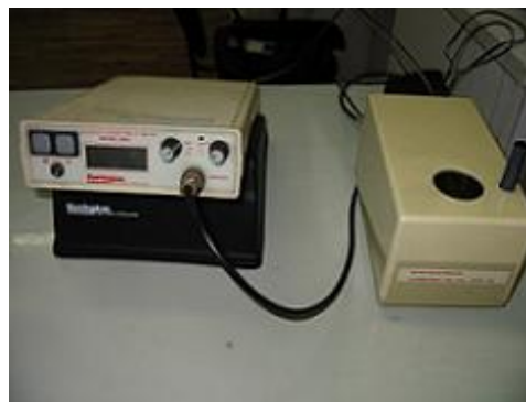
图1 巴廷顿公司生产的MS2磁化率仪，体积小，配以野外探头，可在野外使用
