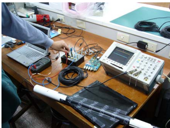
图2 组装一支闪烁体计数器后，先进行基本的量测
