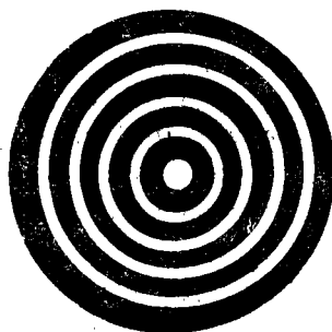
图2 无发散光束实际是一个很强的中心点,被一系列同心环所包围(环的强度反比于离中心的半径), J_0 束的中心点传播得比高斯束远16倍才明显减弱。
