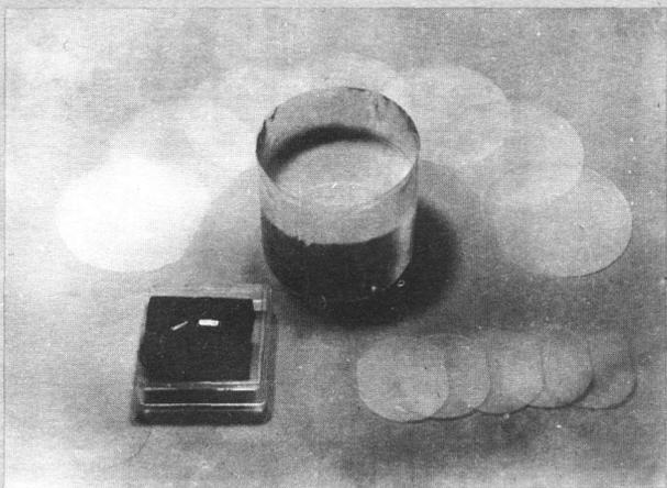
图为82毫米直径的新型压电晶体四硼酸锂。该新材料兼具高机电耦合系数和零延迟温度系数的特点，适用于高频、高稳定性和小型化的声表面波器件的制造，成为电子工业材料中的新秀。它的SAM器件（图右）应用于移动通讯装备上，如寻呼机、汽车电话、无线电话、家用袖珍电话等。九十年代移动通讯将成为信息社会中不可缺少的通讯工具。中国科学院上海硅酸盐所在国际上首创它的新生长技术并发展了其宏观完整生长理论，为四硼酸锂产业化生产奠定了坚实的技术基础。
