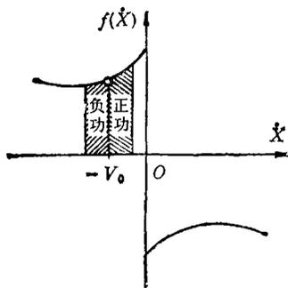
图 19 传送带的摩擦曲线与摩擦力的功
