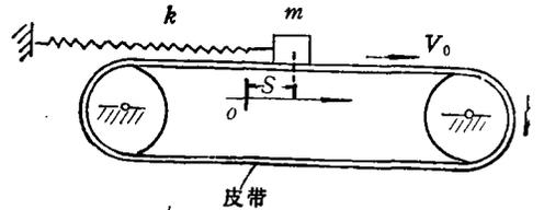
图 17 干摩擦引起自激振动的模型
