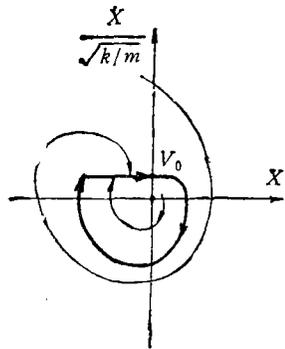
图 20 干摩擦引起振动的极限环
