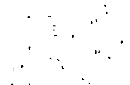
图2 输出饱和激光束在热敏纸上烧焦的黑斑
