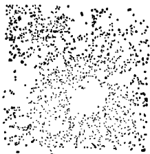
图11 为首次尝试从固定的 Z_0 值取出若干 \mu m 的薄 Z 层,该层对应于图8中的一水平线。这里仅采用灰度值 gv = 83 - 85 。
