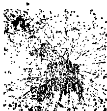
图12 灰度值的截断仅取 gv < 83 ,这样再产生图9的极黑部分。
