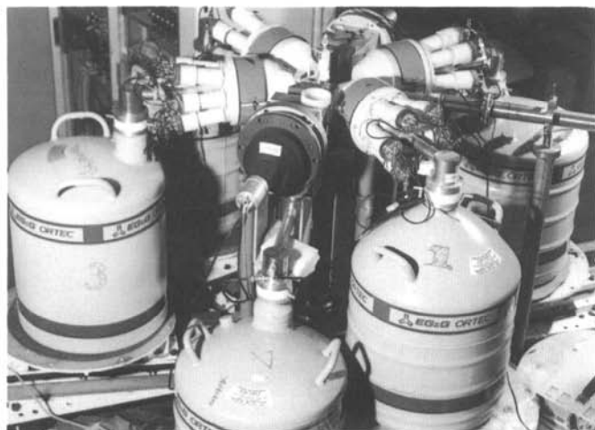
↑ 在束 \gamma 谱学测量装置
