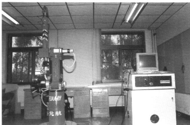
七自由度机器人,是避障和容错能力均优的工业机器人
