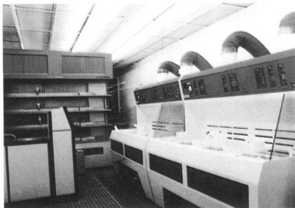
净化级别为10级的亚微米VLSI工艺线
