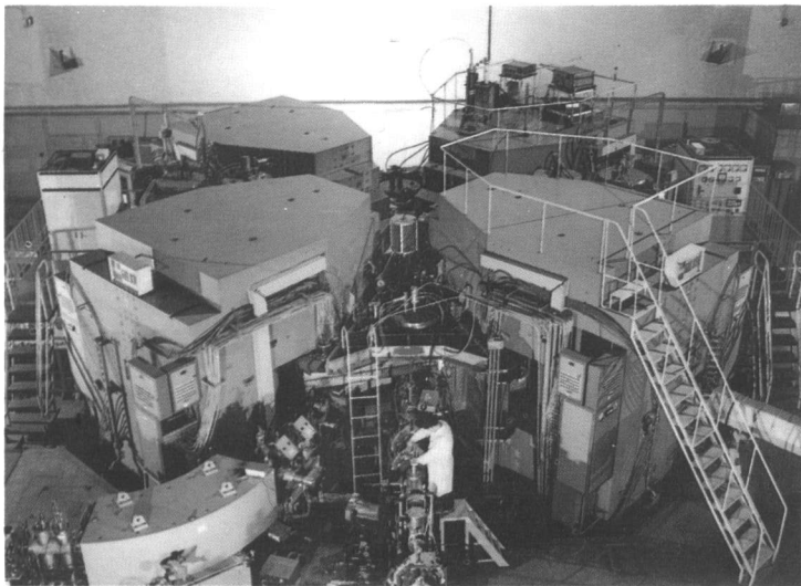
主加速器——大型分离扇回旋加速器
